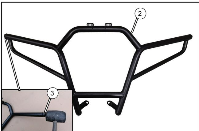
Utilisez un marteau en caoutchouc pour installer les bouchons (3) dans le pare-chocs avant (2).
