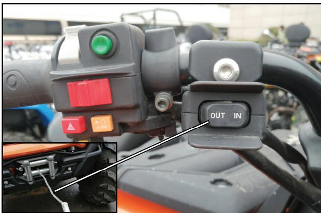
Allumez l'interrupteur à clé principal, puis appuyez et maintenez le bouton 'OUT' du treuil pour laisser sortir le câble du treuil environ 30 cm.
