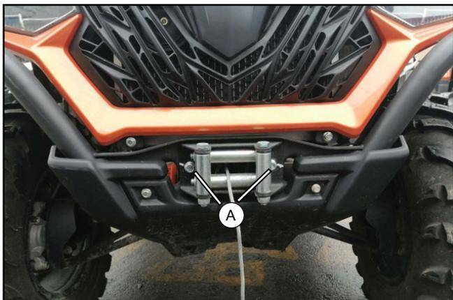
Retirez les boulons du guide-câble du treuil (A).
